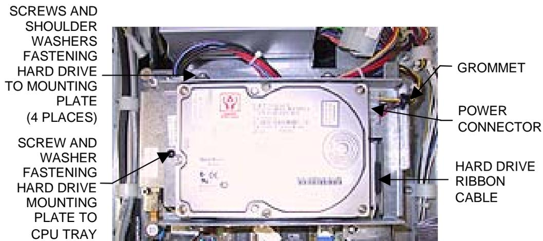
FIGURE 1 - MAXX UPRIGHT - CLOSEUP OF HARD DRIVE
